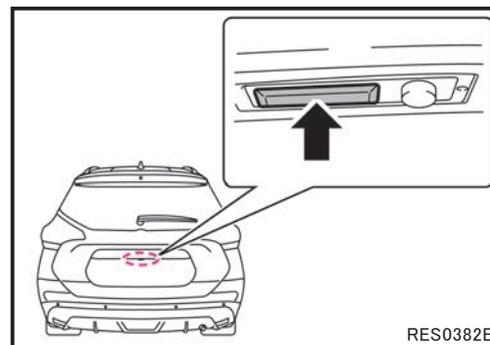
5) 12Vバッテリー①のマイナス端子(A)を取り外し、絶縁テープで覆う。(バックドアのロック部分にテープ等を巻き、ロックしないようにする。) 不可能な場合は、12V系回路が遮断できません。ハーネスのショート、又は衝撃によりSRSエアバッグシステムが突然展開し、重大な障害につながる可能性がありますので、十分な対策を行ってください。
