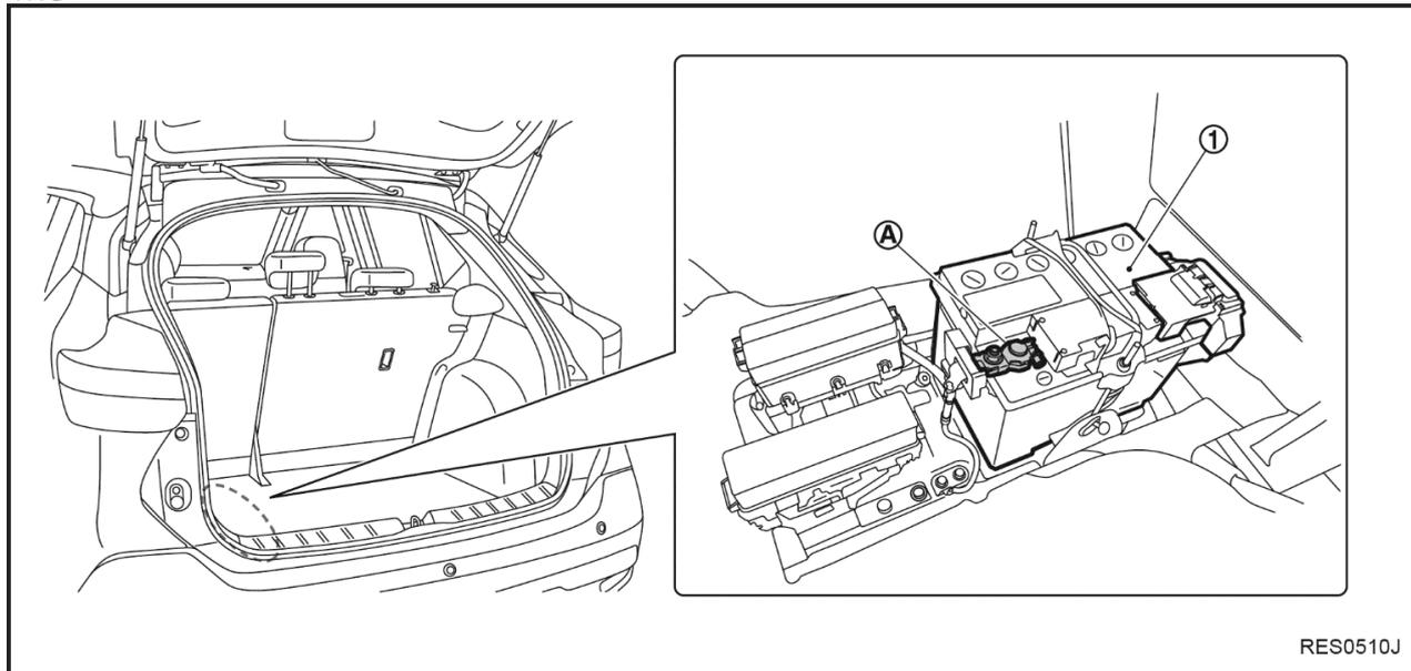
6) パワースイッチ OFF 後、高電圧用コンデンサーの放電が完了するまで、10 分間放置する。
