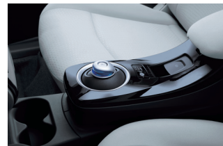
②電制シフトノブ&電動パーキングブレーキ シフトノブはマウスのような形をしています。
