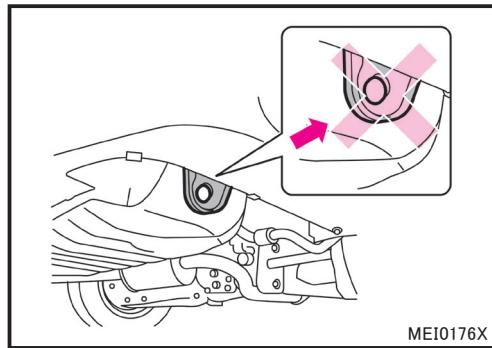
トレーラーなどで輸送するときは、車両下側のスロット穴とタイダウンフックを使い固定してください。
