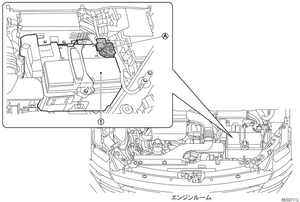
4) 走行可能表示灯が消灯後、高電圧用コンデンサーの放電が完了するまで、10分間放置する。
