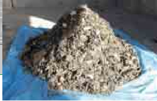
自動車リサイクル法(日本)の特定再資源化物品：シュレッダーダスト
