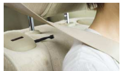
飲酒運転防止コンセプトカーの運転席アルコールセンサー
