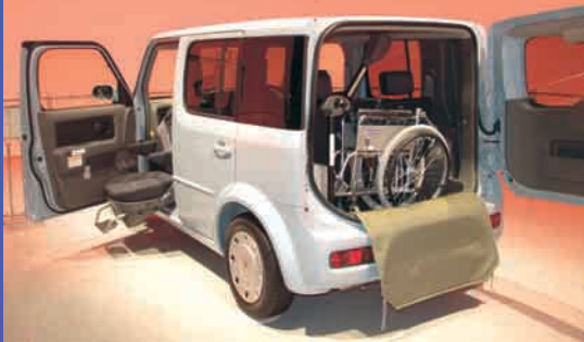
ライフケアビークル「キューブキュービック アンシャンテ」 (助手席スライドアップシート)
