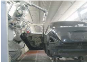
揮発性有機化合物 (VOC) が少ない水系塗装ラインへの切り替え (九州工場)
