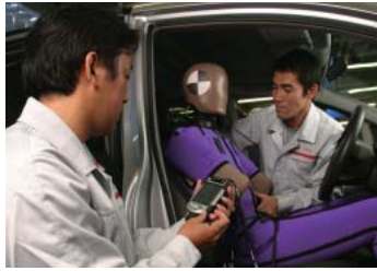
ダミーを使用した衝突実験
