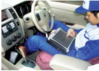
高性能化するクルマの不具合を「電子システム診断装置」 での確に診断
