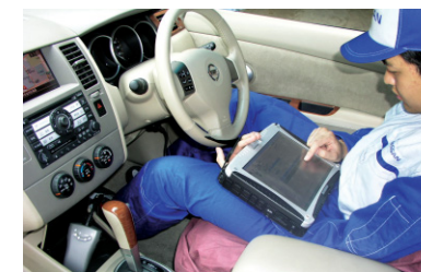
高性能化するクルマの不具合を「CONSULT-Ⅲ」で的確に診断
