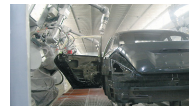
揮発性有機化合物 (VOC) が少ない水系塗装ラインへの切り替え(九州工場)
