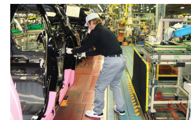
日産生産方式「ストライクゾーン」 改善前（写真上）：作業者がしゃがんだ姿勢で部品を取り付ける 改善後（写真下）：クルマを昇降式コンベアで上下させることで、無理のない姿勢で部品を取り付ける
