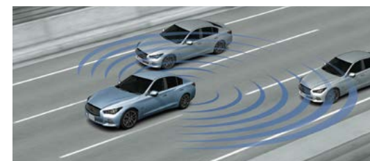
ブラインドスポットワーニングとブラインドスポットインターベンション
