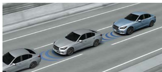
世界初となるプレディクティブフォワードコリジョンワーニング
