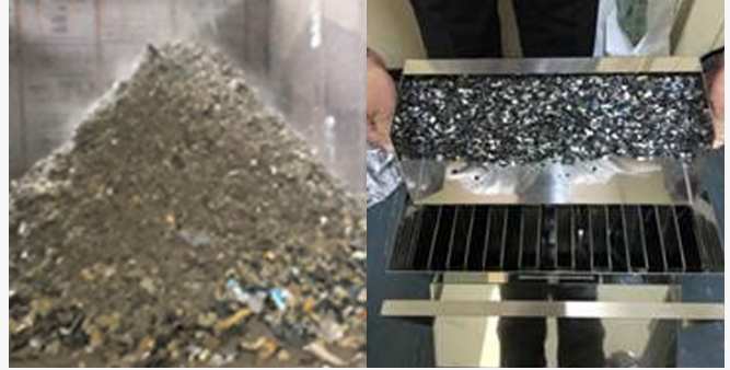
ASR回収樹脂からのリサイクルプロセス最適化の研究。写真左：ASR、写真右：ASRから回収された樹脂
