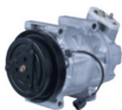
エアコンコンプレッサー
