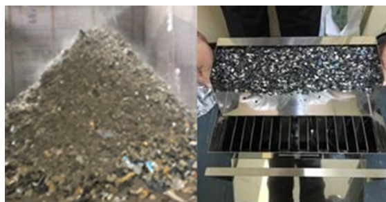
ASR 回収樹脂からのリサイクルプロセス最適化の研究。 写真左：ASR、写真右：ASR から回収された樹脂
