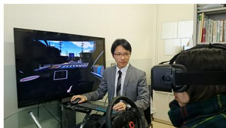
ドライビングシミュレータを使い視覚機能を計測
