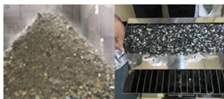
写真左：ASR、写真右：ASRから回収された樹脂
