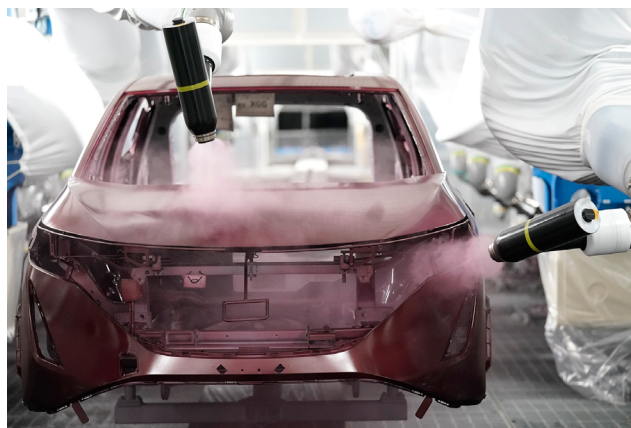
従来2つあった工程(左図)を、新技術でボディ・バンパーを同時に塗装しひとつ(右図)に集約することと低温(85°C)で乾燥させることでCO 2 排出量を削減した。
