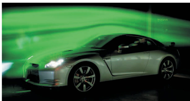
図-6 煙による車体中央断面流れの可視化 Fig. 6 Flow visualization with smoke
