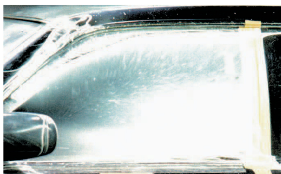
図-7 油膜法によるサイドウィンドウ流れの可視化 Fig. 7 Oil flow visualization pattern on the side window
