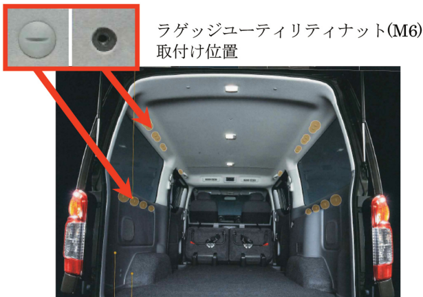
図-6 広くて使い勝手のよい荷室空間およびラゲジューティリティナット(M6)取付け位置 Fig. 6 Spacious, user-friendly cargo space and luggage utility nuts (M6)
