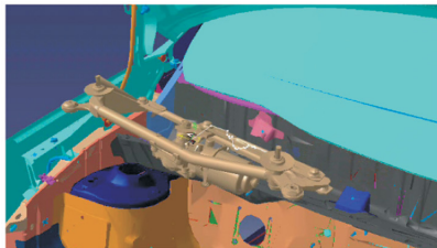
a)部品の取付け軌跡方法の検討 (例：ワイパードライブ取付け)
