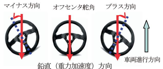
図-9 ステアリングオフセンタ舵角 Fig. 9 Steering off-center angle
