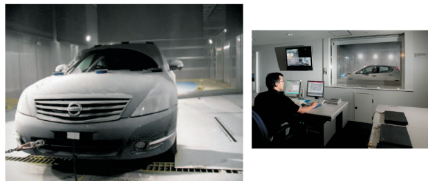
図-1 全天候型環境試験室 Fig. 1 All weather environment test chamber
