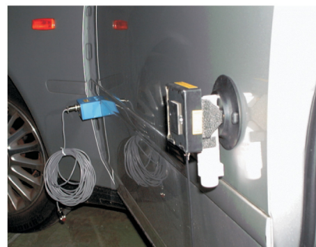
図7 角速度計（ジャイロセンサ）使用による ドア閉じ性能評価
