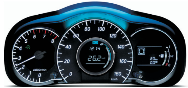
図-2 日産ノート搭載エコドライブインジケータ (メータ上部のしま状の濃淡変化がエコ状態の表示部) Fig. 2 Eco-drive indicator
