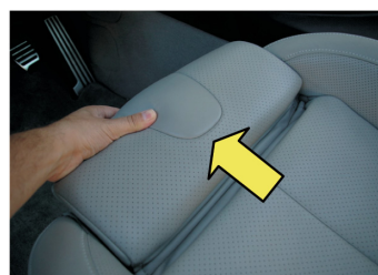
図-2 サイサポートアジャスターの例 Fig. 2 Example of thigh support adjuster
