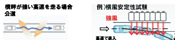
図-3 横風発生試験例 Fig. 3 Cross wind test
