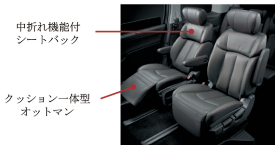
図-1 コンフォタブルキャプテンシート Fig. 1 Comfortable Captain Seat
