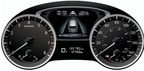
図-3 液晶ディスプレイ付メーター Fig. 3 Meter cluster with liquid crystal display
