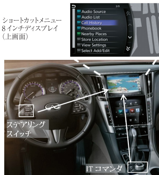
図-5 ショートカットメニューの操作 Fig. 5 Control devices for shortcut-menu operation
