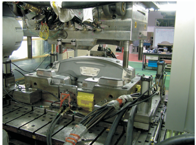
図-17 インストルメントパネル表皮の成形機 Fig. 17 Molding machine for instrument panel skin
