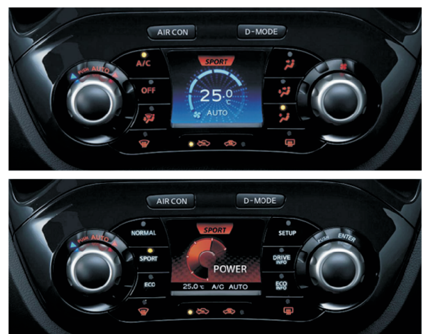
図-3 日産ジューク搭載インテリジェントコントロールディスプレイ (上段がエアコン操作時、下段がドライブモード操作時) Fig. 3 Intelligent Control Display
