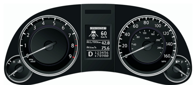
図-5 Infiniti JX 搭載のアドバンスド・ドライブアシスト・ディスプレイ付メーター Fig. 5 Infiniti JX cluster meter with Advanced Drive-Assist Display
