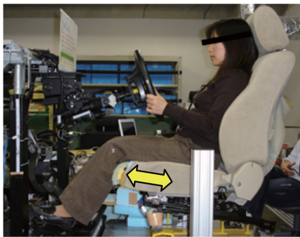
図-3 最適クッション長さ探索用の実験装置 Fig. 3 Experimental seat devices for searching comfortable cushion length
