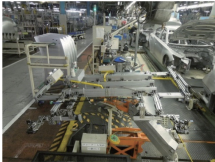
図-73 フロントフェンダ建付け治具助力装置 Fig. 73 Front fender setting jig assistance device
