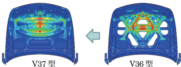
図-53 インナーフードのひずみマップ Fig. 53 Hood inner strain map
