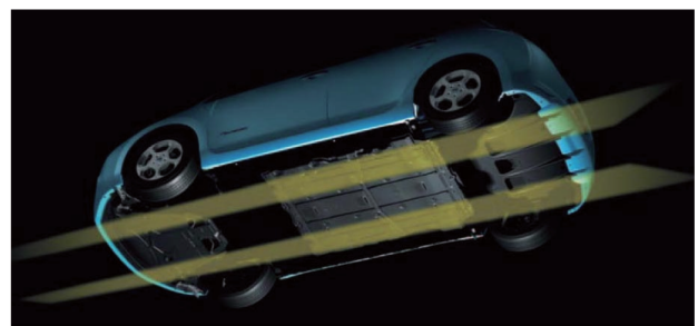
図6 車両下面デザインと整流効果
