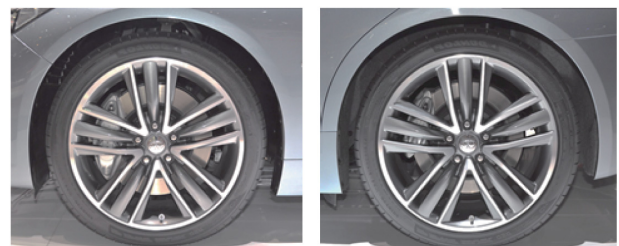
図-56 フェンダとタイヤの隙間（V37型） Fig. 56 Fender arch-tire (V37)
