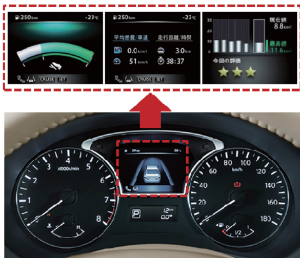
図-6 アドバンスドドライブアシストディスプレイとディスプレイ表示例 Fig. 6 Advanced drive assist display and display examples
