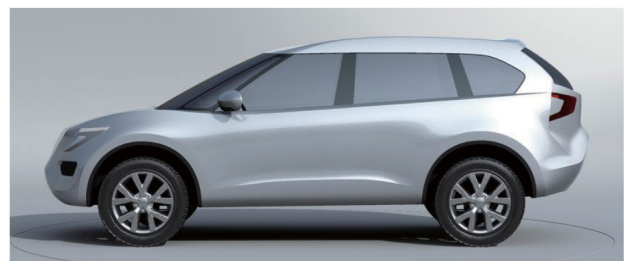
図-4 初期のプロポーション確認モデル Fig. 4 Preliminary proportion model
