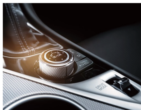
図-7 マルチファンクションスイッチとドライブモードセレクタ
