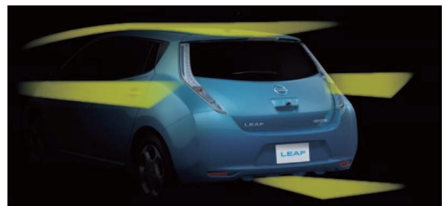
図5 車両後部デザインと整流効果
