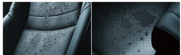
図-4 防水シートと防水フロア Fig. 4 Waterproof seat and floor
