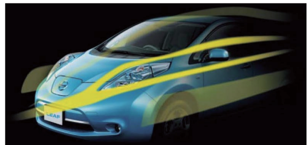
図4 車両前部、側部デザインと整流効果
