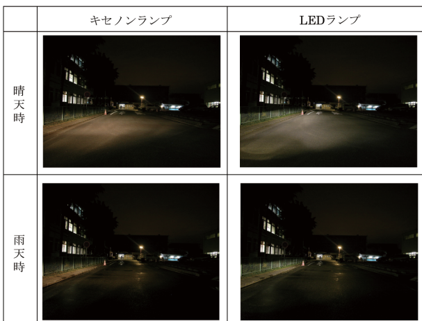
図-40 キセノンランプとLEDランプの視認性比較
