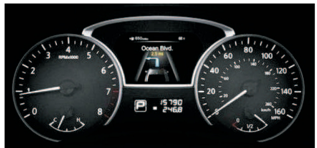
図-14 情報表示メータの例 (Maxima) Fig. 14 Example of information display (Maxima)
