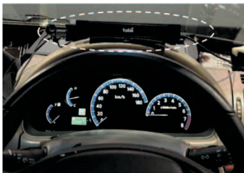
図-11 アイトラッカー設置状態 Fig. 11 Installation of eye tracker
