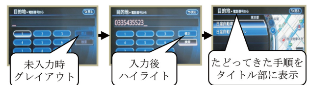
図-6 明示的入力フロー例 Fig. 6 Example of explicit input flow
