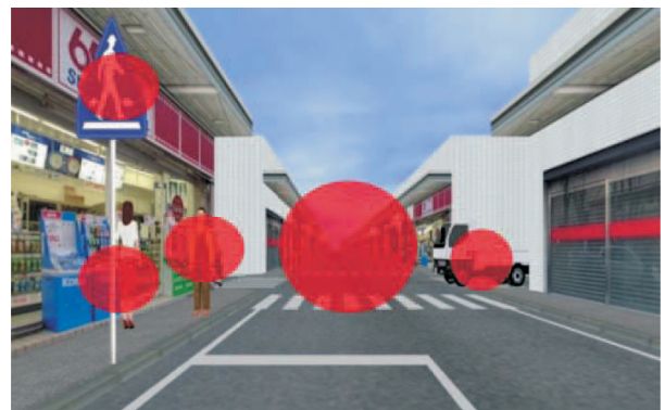
図-13 視線停留時間による注意配分分析 Fig. 13 Analysis of attention distribution
