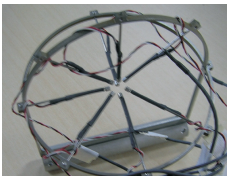
図-8 試作マイクロホンアレイ Fig. 8 Prototype of microphone array
