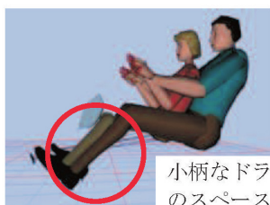
図-1 体格別の膝周辺スペース評価例 Fig. 1 Knee space evaluation of different body size
