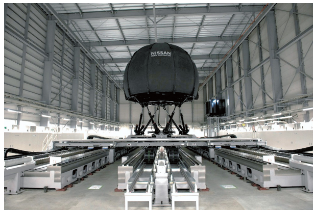
図-1 ドライビングシミュレータ外観 Fig. 1 Appearance of driving simulator
