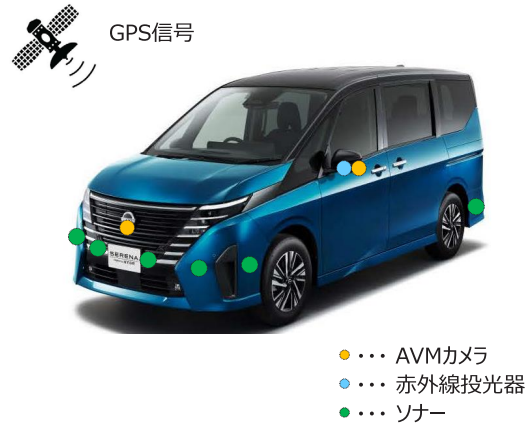
図4 メモリー付きプロパイロットパーキングの部品構成
