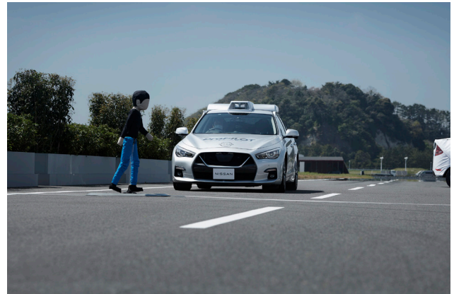
図7 試作車による緊急操作の自動化
