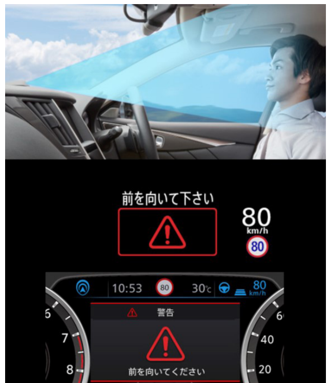
図12 ドライバーモニターによる前方注視を促す警報
