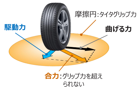
図6 タイヤグリップ力と駆動力
